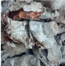
Dans le four de l'usine d'incinération des ordures, le verre et les métaux ne peuvent pas être brûlés. Le feu n'est pas assez chaud. Ils restent dans les scories.
